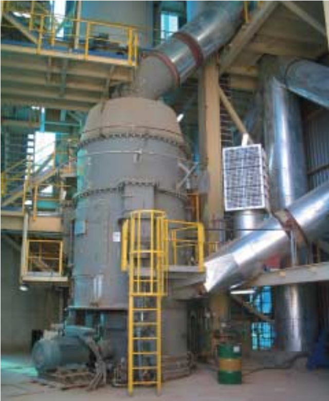
5 MPS 225 BK zur Kohlemahlung mit vorgeschaltetem Druckentlastungssystem 5 MPS 225 BK for coal grinding with preceding pressure relief system
