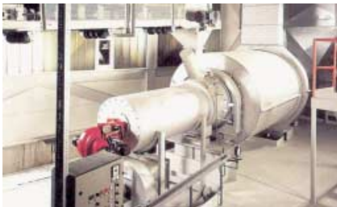
Bild 2: Dreizugtrockner TRT mit Heißgaserzeuger Fig. 2: TRT Triplex dryer with hot gas generator
