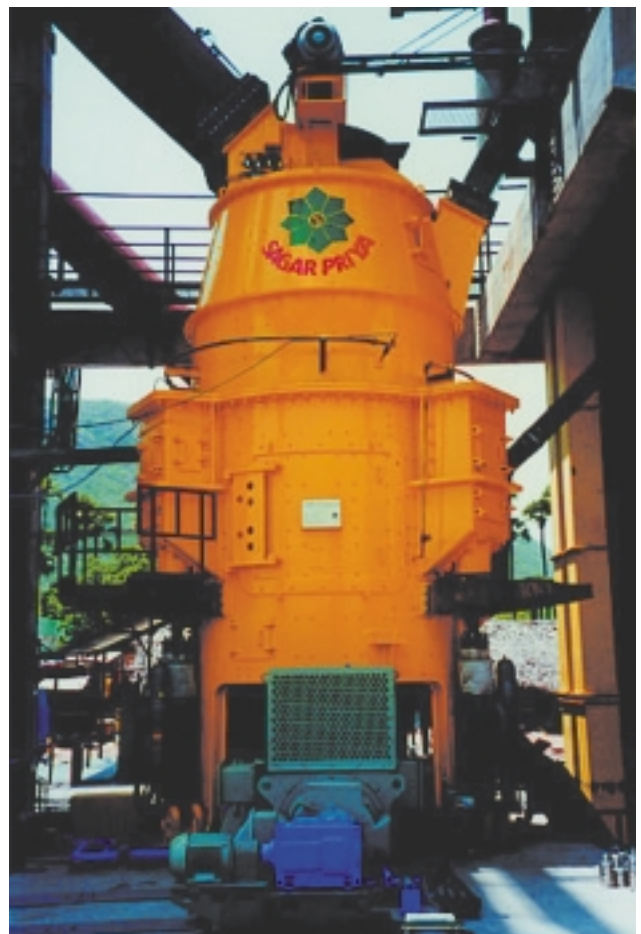
BILD 1: MPS-Walzenschüsselmühle 2500 BC bei Sagar Cement in Bayyavaram/Indien
