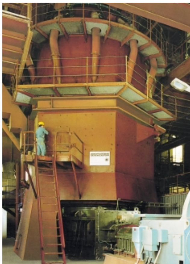
BILD 1: Die von der Gebr. Pfeiffer AG gelieferte Walzenschüsselmühle MPS 3750C für die Herstellung von Hochofenzementen bei der Teutonia Zementwerk AG, Hannover
