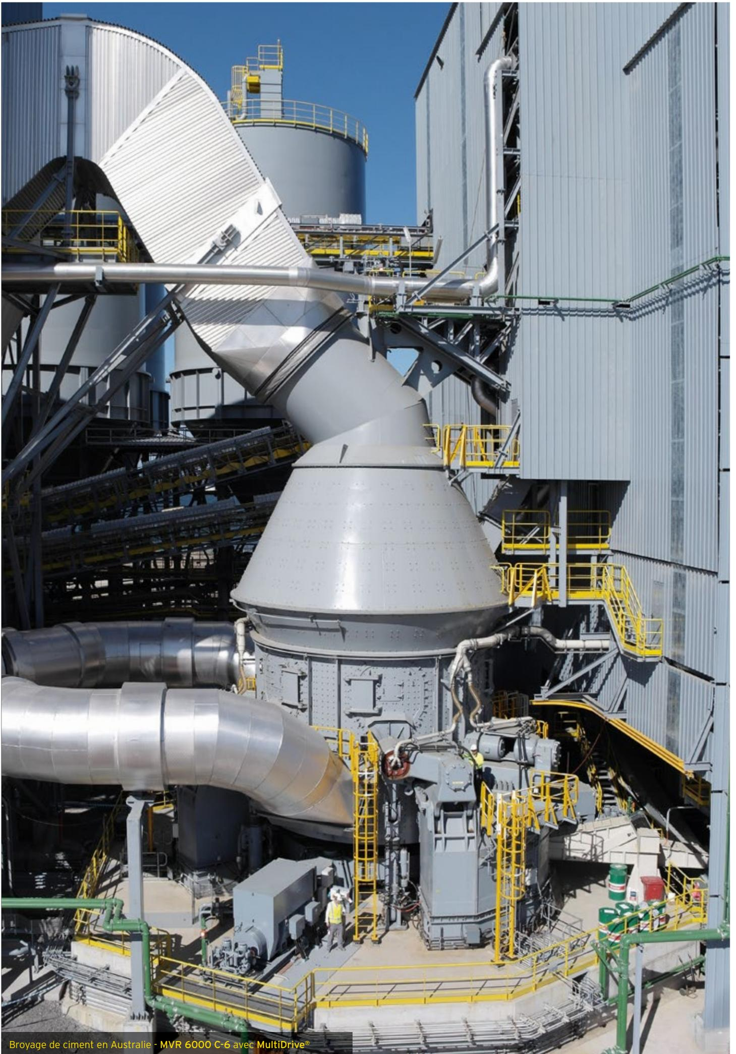
Broyage de ciment en Australie - MVR 6000 C-6 avec MultiDrive®
