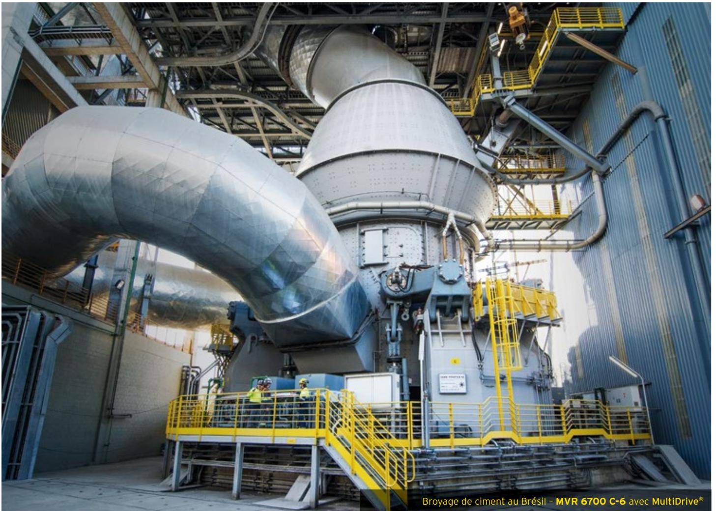
Broyage de ciment au Brésil - MVR 6700 C-6 avec MultiDrive®
