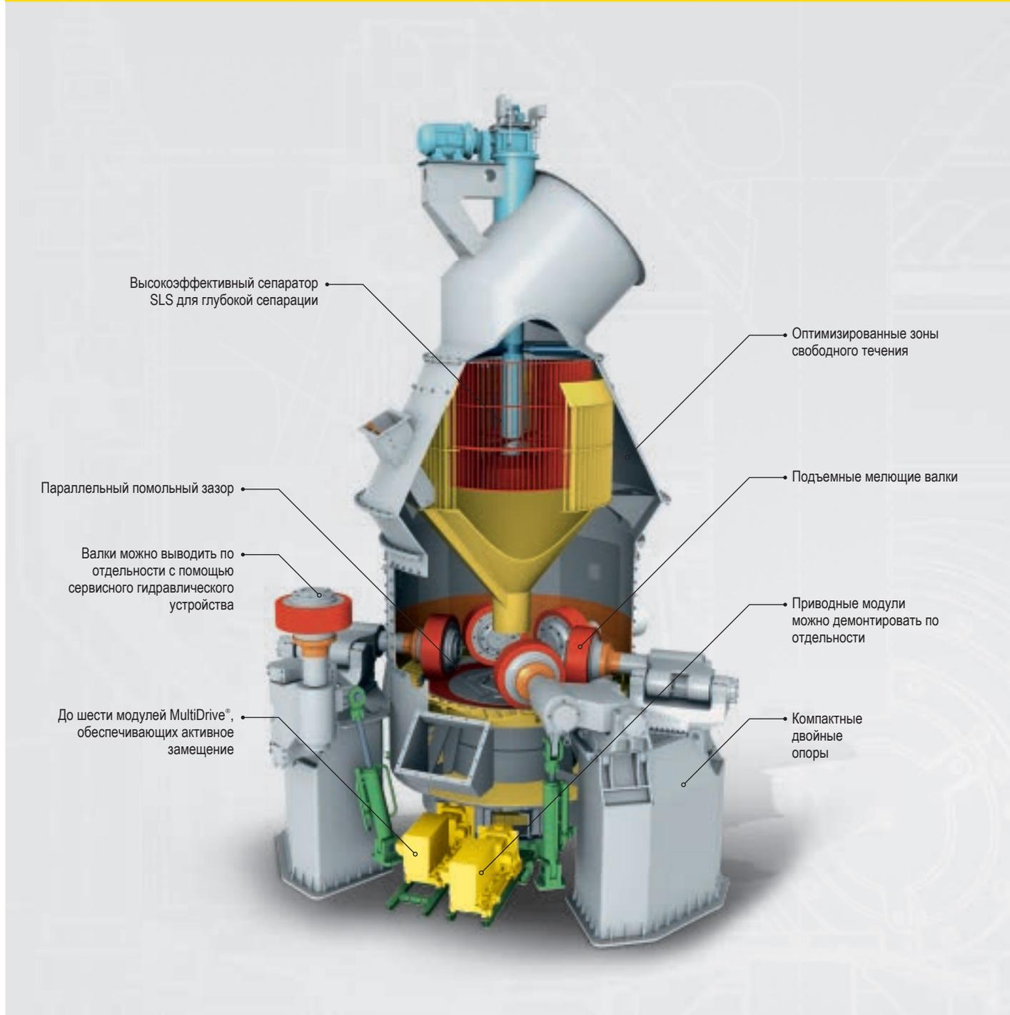
Мельница MVR является оптимальным решением для обеспечения большой производительности благодаря лёгкой доступности и активного замещения валков и системы привода (MultiDrive®), высокой износостойкостью и удобством в обслуживании.
