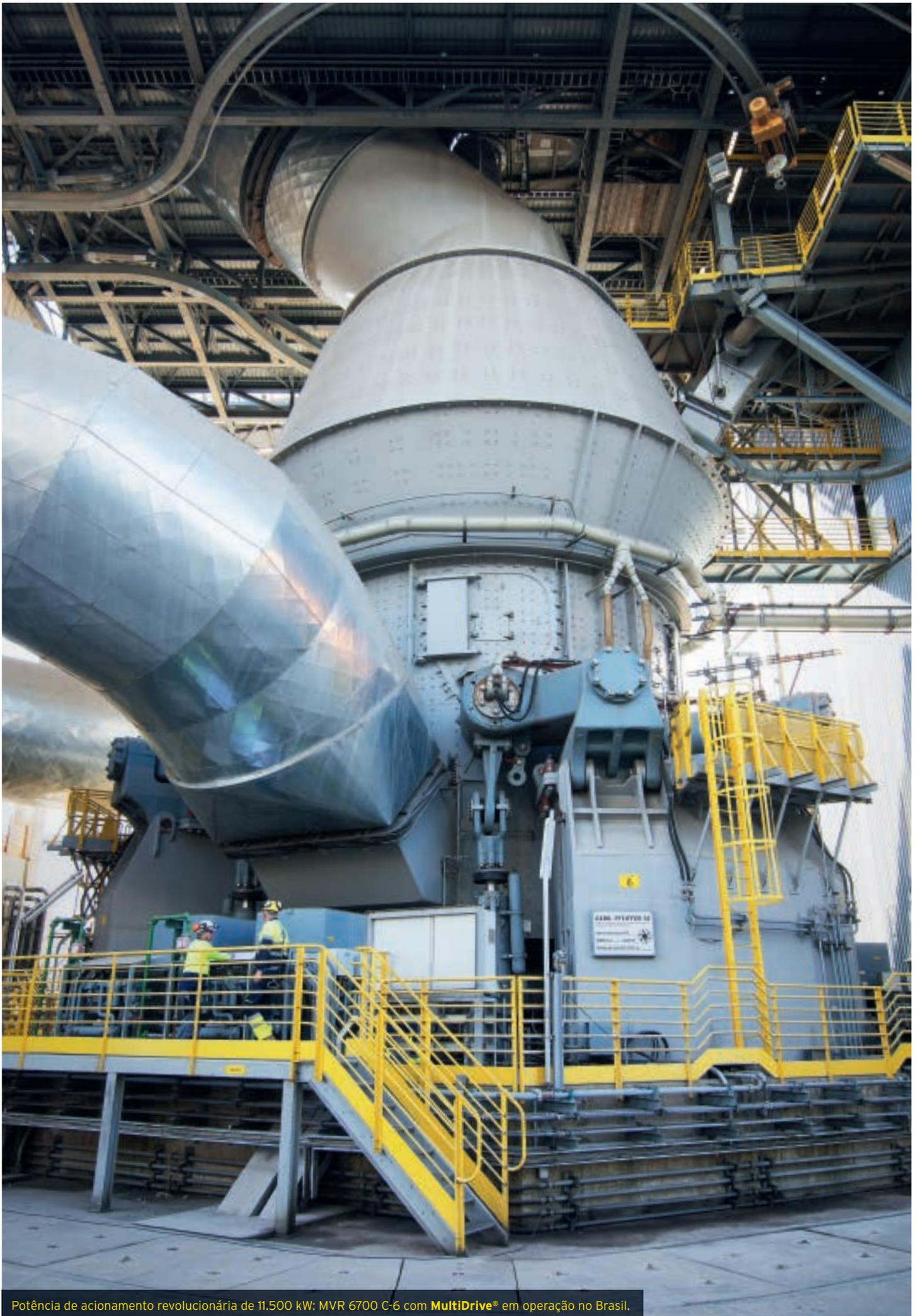
Potência de acionamento revolucionária de 11.500 kW: MVR 6700 C-6 com **MultiDrive®** em operação no Brasil.
