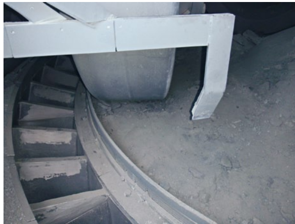
2 View of a grinding roller in an MVR Blick auf die Mahlwalze einer MVR
