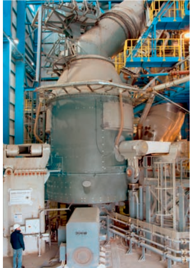
5 MVR-R 3750 for cement raw material, 1600 kW MVR-R 3750 für Zementrohmaterial mit 1600 kW
