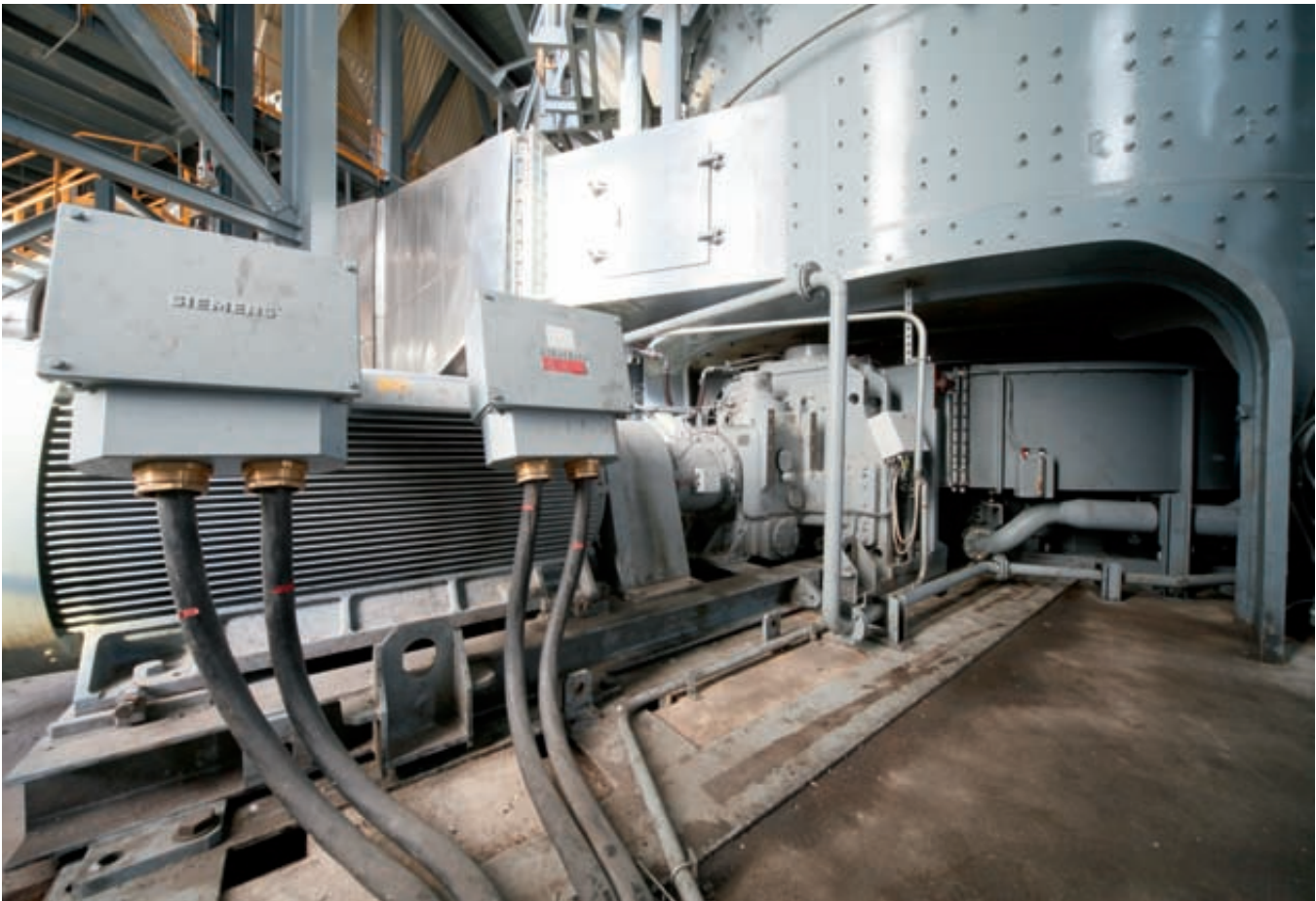
6 MultiDrive® with 1450 kW modules for Holcim/France • MultiDrive® mit 1450-kW-Modulen für Holcim/Frankreich
