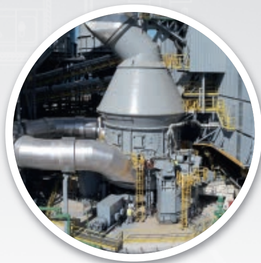
Broyage de ciment et de laitier granulé de haut-fourneau avec des broyeurs verticaux MVR
