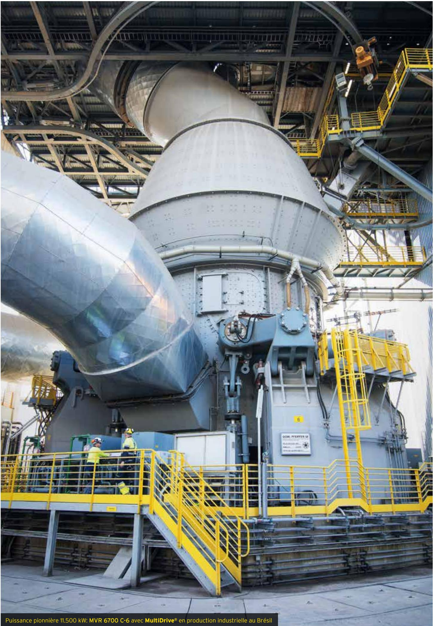
Puissance pionnière 11.500 kW: MVR 6700 C-6 avec **MultiDrive®** en production industrielle au Brésil
