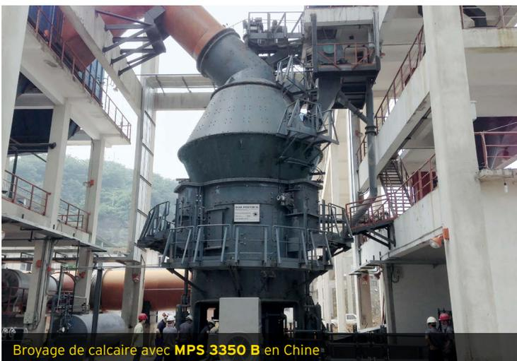
Broyage de calcaire avec **MPS 3350 B** en Chine
