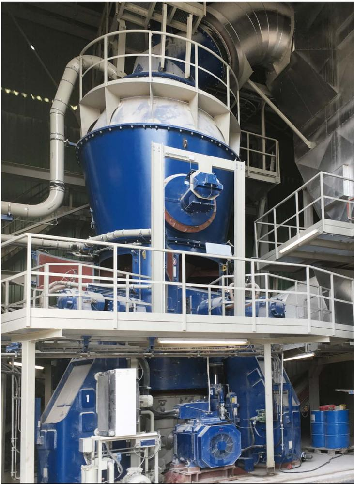
Broyage ultrafin de calcaire en Allemagne avec **MVR 1800 R-4**
