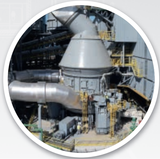
Zement- und Hüttensandmahlung mit MVR-Walzenschüsselmühlen
