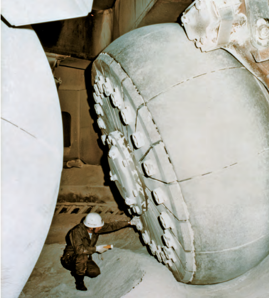
1 | 2 Innenleben und Außenansicht der damals größten Vertikalmühle der Welt, MPS 4850 A, die Gebr. Pfeiffer 1976 nach Japan liefert.
