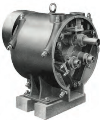
Einfache Idee, große Wirkung: Die Dreivalzenmühle wird in den 1920er Jahren zum Erfolgsmodell von Gebr. Pfeiffer.
